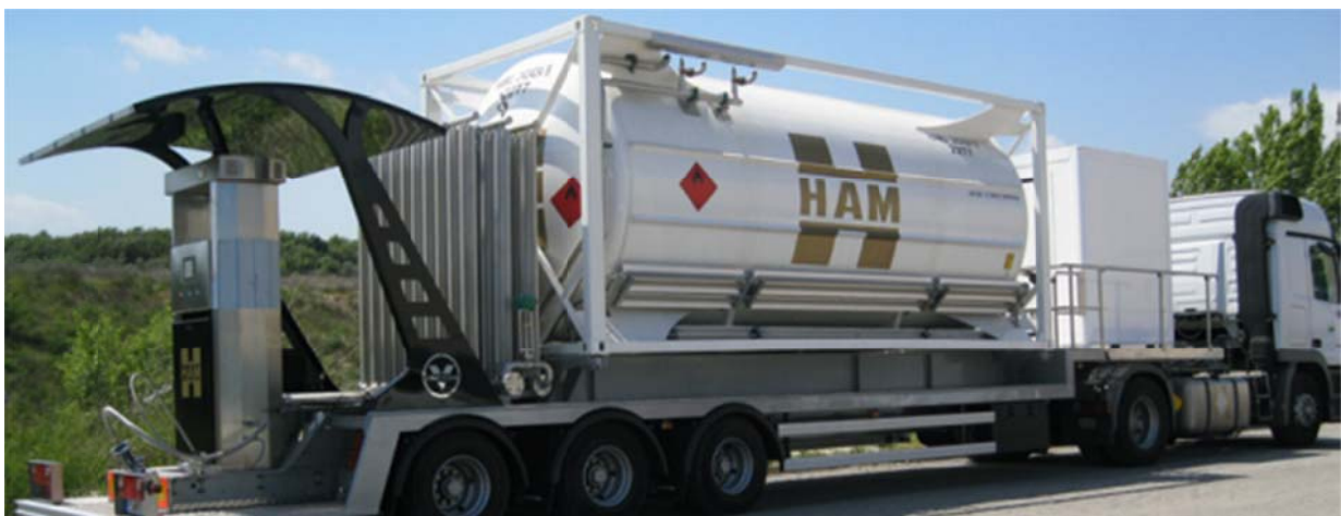
Imagen 14. Fotografía de una estación móvil de recarga de gas natural. Fuente: José Ramón Freire López. Gas Natural Fenosa, 2014
