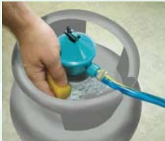
En cada cambio de garrafa, haga la prueba de espuma: aplique una esponja empapada en agua y jabón sobre la conexión entre el regulador y la garrafa.
