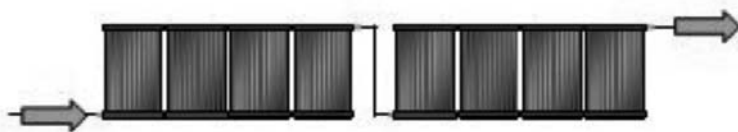
Figura 9.6 Interconexión entre baterías en serie.
