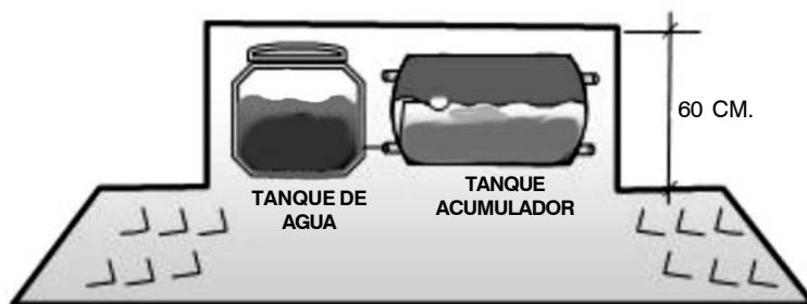
Figura 6.19 – Tanque de agua y TA. Instalación en nivel
