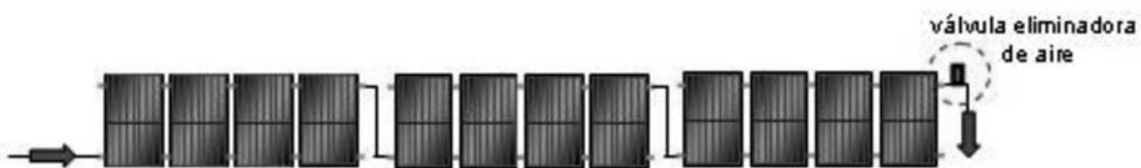
Figura 8.8 - Ubicación de la válvula eliminadora de aire
