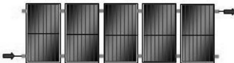
Figura 7.12 - Asociación en paralelo de una batería de 5 colectores solares
