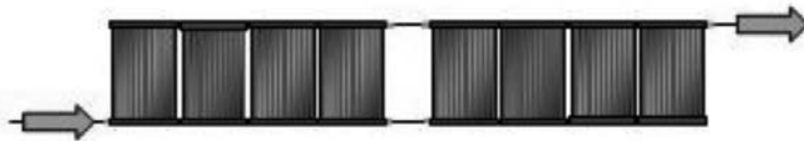
Figura 9.7- Interconexión entre baterías en paralelo
