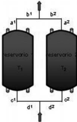
Figura 7.2. Asociación en paralelo de dos tanques térmicos
